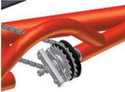
Accionamiento rígido (con embrague deslizante) Piñón fijo (con enganche deslizante)
