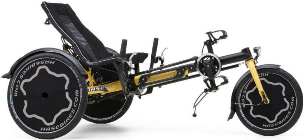
Trix con ajuste rápido del cuadro El ajuste rápido del cuadro permite cambiar el cuadro sin cambiar la longitud de la cadena.
